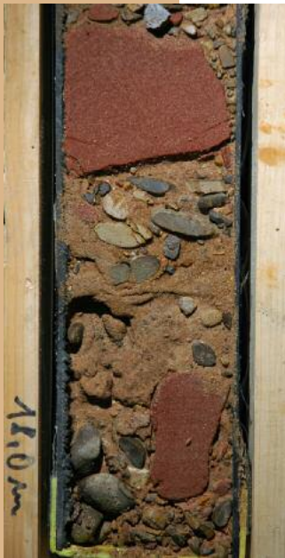
Bohrkern aus der Forschungsbohrung bei Viernheim.
